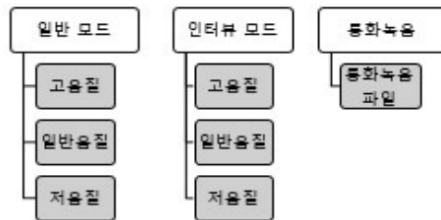
그림 1. 갤럭시 S10의 녹음 모드와 녹음 음질 설정 Fig. 1. Setting of recording mode and recording quality of Galaxy S10
